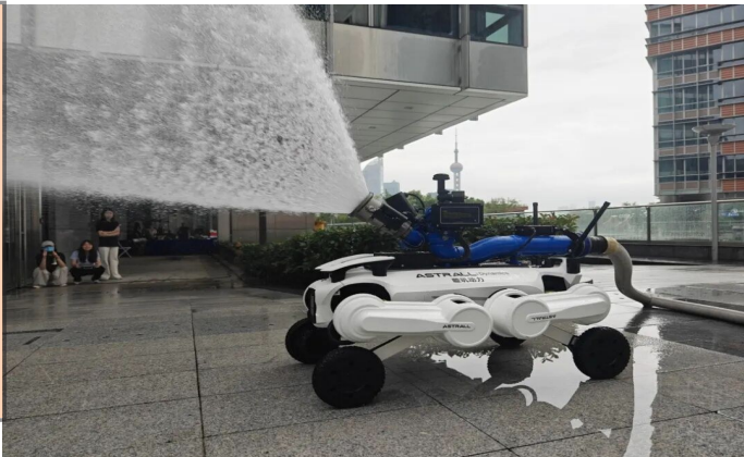
北外滩滨江：开展商务楼宇演练，消防机器人对底层起火部位展开灭火行动。
