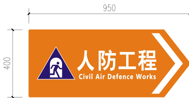
图2 《人防工程指示牌》样式示例
